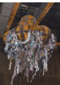
L'un des deux grappins de la chaufferie de Skattøra, photo FD
