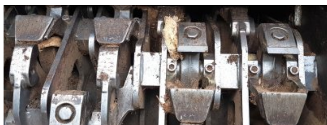
Le rotor de l'Axtor 4510, équipé en mode déchiquetage, photo Hantsch
