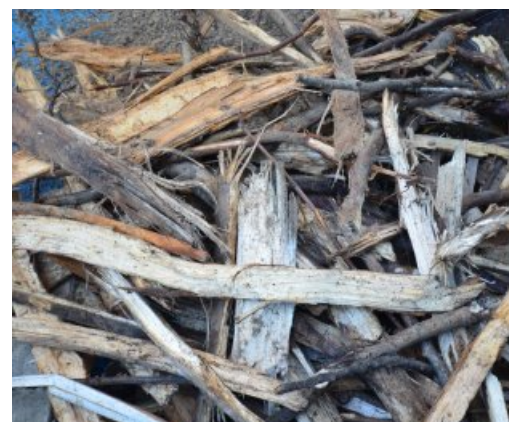
Les refus de crible à la chaufferie bois du Fort de l'Est, photo FD
