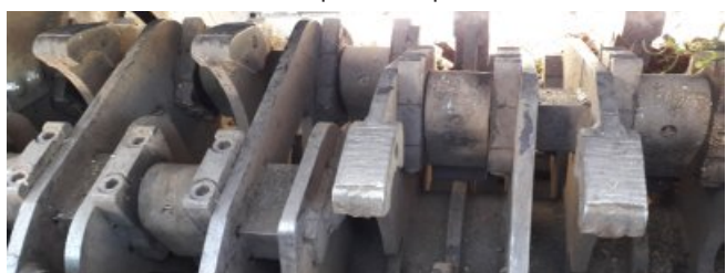
Le rotor de l'Axtor 4510, équipé en mode broyage, photo Hantsch
